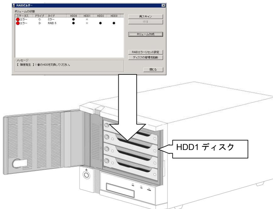
※本説明では、HDD1(上から2台目)のハードディスクドライブが故障した場合について、図を用いてスペアドライブの交換手順についてご説明致します。
