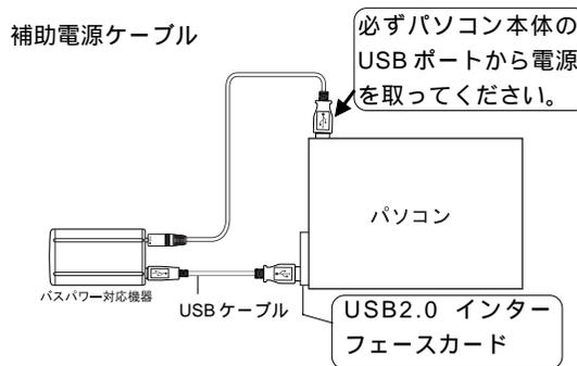
補助電源ケーブルのDCプラグは必ずバスパワー対応機器側に接続してください。
