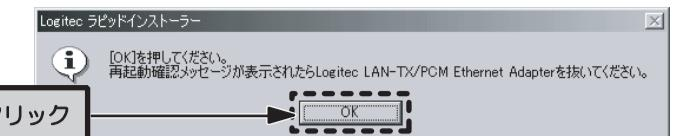
⑥ [再起動確認] ダイアログが表示されますので、パソコンのPCカードスロットのイジェクトボタンを押して本製品を取り外し、「OK」ボタンをクリックします。パソコンを再起動したら、アンインストールは完了です。
