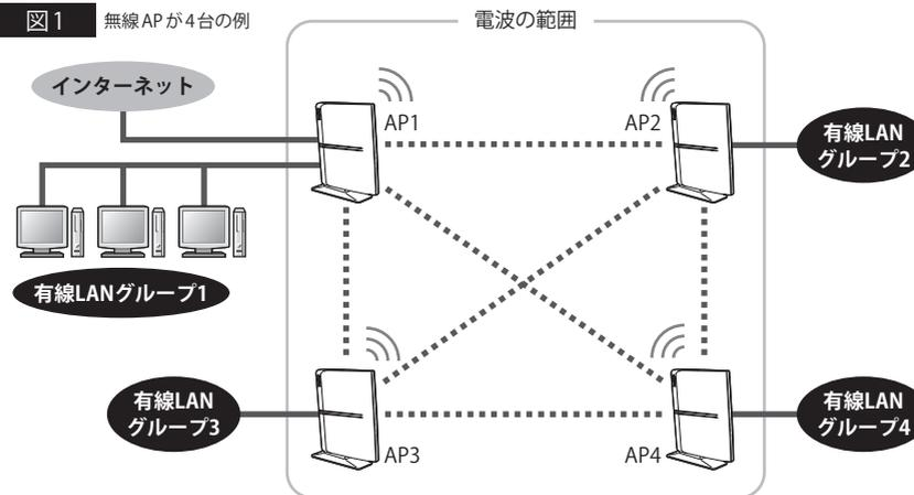
図1のようにAP1～AP4は、お互いが電波の届く範囲にあれば、それぞれのAP同士が直接通信することができます。また、図2のようにAP1とAP3が直接通信できない距離にある場合でも、AP1とAP3がそれぞれAP2と通信できる距離にあれば、AP1とAP3は、AP2を中継することで通信できます。
