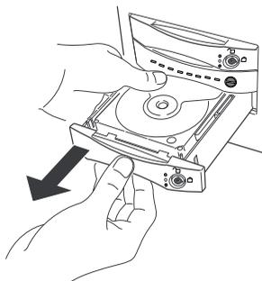
新しいスペアドライブをセットします。力を込めて奥まで挿入し、軽く引いて抜けないことを確認してください。ドライブに衝撃が加わらないようご注意ください。
