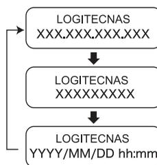
液晶パネルに本製品のコンピュータ名と IP アドレス、またはシステムのバージョンと日付・時刻が表示されます。本製品の管理・設定の際は IP アドレス等をこの液晶パネルでご確認ください。
