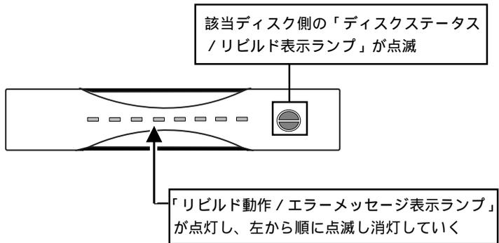
中央の表示ランプが全て消灯したら、再構築は終了です。正常動作に戻ると、リビルド動作 / エラーメッセージ表示ランプが、左右に点灯を繰り返します。これで本製品はミラーリング状態に戻りました。
