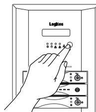
電源表示ランプが点灯し、液晶パネルに「System starting. Please wait...」と表示されます。
