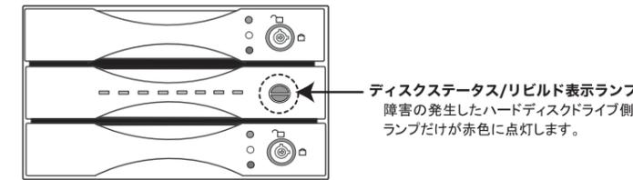
※リビルド動作/エラーメッセージ表示ランプ(中央のインジケータ)および、ディスク動作表示ランプ(各ドライブについている緑・黄・赤の3つのランプ)でも、ディスクの状態を確認することができます。これらのランプの機能および、点灯仕様については、CD-ROM収録のハードウェアマニュアル第1章の「1. 2 各部の名称と機能」をご参照ください。
