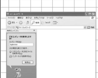
ツールバーの「検索」をクリックし、検索コンパニオンの「コンピュータ名」の欄に本製品のサーバーアプライアンス名かIPアドレスを入力します。「検索(R)」をクリックし、見つかったコンピュータのアイコンをダブルクリックすると共有フォルダ(Public)が現れます。
