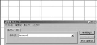
「コンピュータ名(M)」の欄に本製品のIPアドレスかサーバーアプライアンス名を入力し、「検索開始(S)」をクリックします。見つかったコンピュータのアイコンをダブルクリックすると共有フォルダが現れます。
