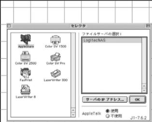
AppleShareを選択し、「ファイルサーバの選択」に現れたリストからサーバーホスト名を選択します。サーバーホスト名が現れなければ、「サーバーのIPアドレス」をクリックして、IPアドレスを入力し、「接続」をクリックします。ユーザ名とパスワードを求めてきますので、特に本製品にユーザ登録していなければguestを選択します。
