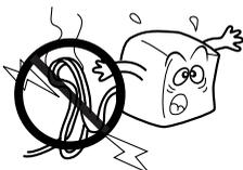
ACアダプタのコードは必ず伸ばした状態で使用してください。束ねた状態で使用すると、過熱による火災の原因となります。
