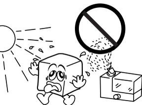
高温・多湿の場所、長時間直射日光の当たる場所での使用・保管は避けてください。また、周辺の温度変化が激しいと内部結露によって誤動作する場合があります。
