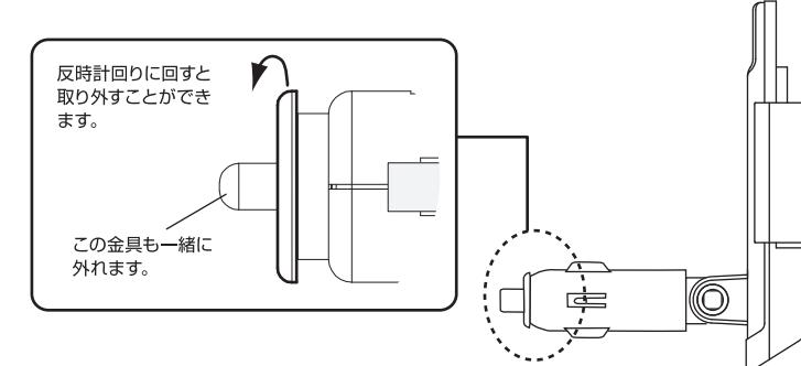
**!** 差し込み口を外すと、先端の金具も一緒に外れます。
