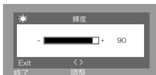
本製品の輝度調整は、仕様によりバックライトの明るさではなく、ゲインコントロールで入力信号を電氣的に増幅する方式をとっています。この方式はバックライトの明るさを調整する方式に比べて、明るさの変化が大きくありませんが、これはディスプレイの異常ではありません。明るさの変化が分かりにくい場合は、ディスプレイ上に白い画面を表示して、ブライトネスの調整を試みてください。
