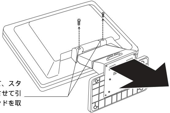
この2カ所のネジを外して、スタンドを下方向にスライドさせて引き抜くと、本体からスタンドを取り外せます。
