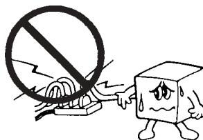
電源コードは必ず伸ばした状態で使用してください。束ねた状態で使用すると、過熱による火災の原因となります。
