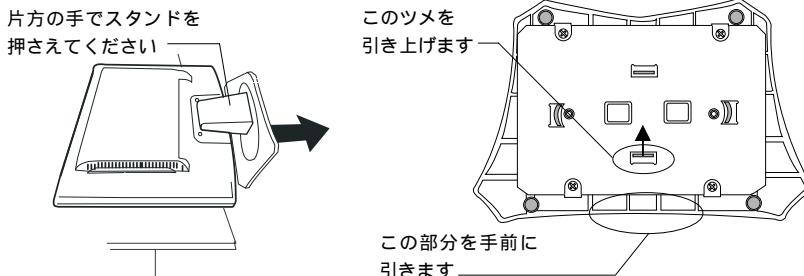
⚠️ 台座は設置時の安定を保つため、取り外しにくいように設計されていますが、正しい方向に引けば、外れるようになります。手前に引きながらツメが外れたのを確認したら、少し強めに引き抜いてください。このときに引き抜く力で本体が動かないようご注意ください。機器の破損やケガの原因となります。
