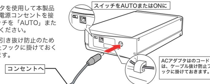
※電源スイッチをAUTOに設定しておくと、PC電源連動機能が有効になり、パソコンの電源のON/OFFに本製品の電源も連動して切り替わるようになります。
