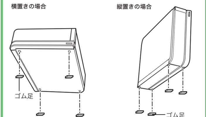
※いずれの方向で設置する場合も、転落・引き抜け防止措置をとってください。本製品が動作している状態での転落や、コネクタ類の引き抜けは故障・データ消失の原因となります。
