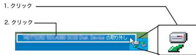
②取り外し処理が完了すると、「デバイスは取り外すことができます。」とメッセージが表示されますので、「OK」ボタンをクリックして、接続デバイスを取り外してください。
