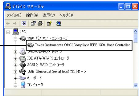
「1394 バスホストコントローラ」を開いたときに、「Texas Instruments OHCI Compliant IEEE 1394 Host Controller」が表示され、「！」マークがついていなければ、本製品は正常に認識されています。右上のクローズボックス (×) をクリックしてデバイスマネージャを閉じてください。
