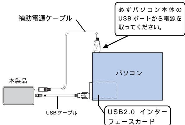
補助電源ケーブルのDCプラグはバスパワー対応機器(本製品)側に接続してください。
