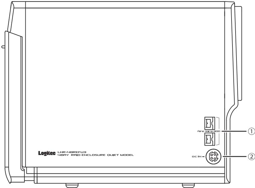
① Firewire800 ポート：Firewire800 を接続します。(LHR-4BREFU3 のみ)
