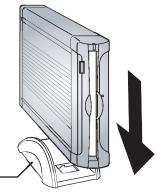
横置きの場合、設置時、底面の4箇所に 付属のゴム足を貼り付けしてください。 (右図参照) 付属ゴム足
