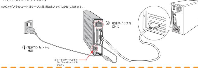
パソコンの電源をONにしてください。本製品が使用可能となります。 4 以下を参考にパソコンから正しく認識されていることを確認してください。
