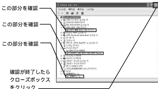
これらのデバイスが表示されたら、本製品の接続と認識は正常に行われています。次にMOメディアのフォーマットについて説明しますので、クローズボックスをクリックして、ウィンドウを閉じてください。
