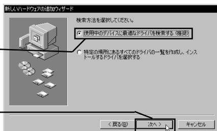
右下のウィンドウが表示されたら、CD-ROM ドライブに本製品付属の「Logitec Ware」CD-ROM をセットしてください。
