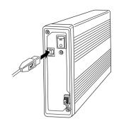
USB 2.0 対応ケーブルのもう 片方のコネクタを本製品の USBポートに接続してくださ い。
