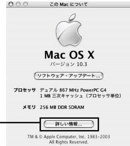
「システム特性」画面が表示されます。「ハードウェア」欄の「USB」をクリックし、「USB装置ツリー」欄に「USB高速バス」が表示され、その下に本製品に接続されているUSB 2.0対応機器のデバイス名が表示されいたらUSB 2.0 High-Speedモードで動作しています。
