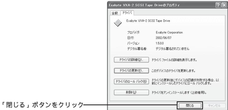
最後に「デバイスマネージャ」ウィンドウで「テープドライブ」のカテゴリに「Exabyte VXA-2 SCSI Tape Drive」が登録されているかを確認し、クローズボックスをクリックしてください。
