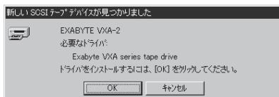
ドライバのインストールが行われ、「テープデバイス」ウィンドウが表示されます。デバイス名が「EXABYTE VXA-2 (ドライバは読み込まれました)」と表示されていることを確認し、「OK」ボタンをクリックしてください。
