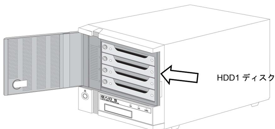
※本説明では、HDD1(上から2台目)のハードディスクドライブが故障した場合について、図を用いてスペアドライブの交換手順についてご説明致します。
