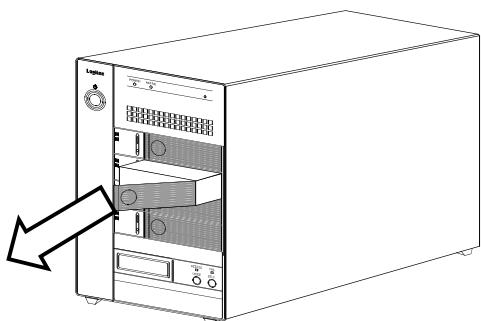
⑤ 新しいスペアドライブをセットします。力を込めておくまで挿入し、軽く引いて抜けない事を確認してください。ドライブに衝撃が加わらないようにご注意ください。
