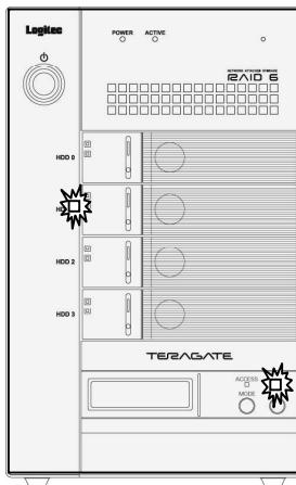
障害の発生したハードディスクドライブの POWER 表示ランプがオレンジ色に点灯します。
