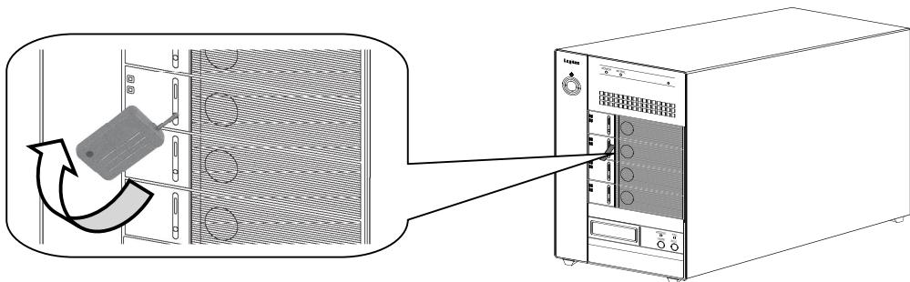
⑧ オートリビルド機能によってデータのリビルド(再構築)が自動的に開始されます。リビルド中であることは、HDD モジュールの表示ランプで確認することができます。
